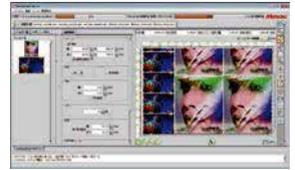
3 Múltiples trabajos de impresión de 3 capas se pueden colocar en el mismo medio de impresión. La función de diseño automático optimiza el diseño de los trabajos de impresión para reducir el consumo de medios.
